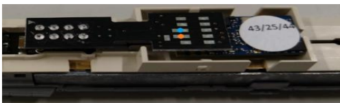
Abbildung 3: Anschlusspunkte der Lautsprecher
